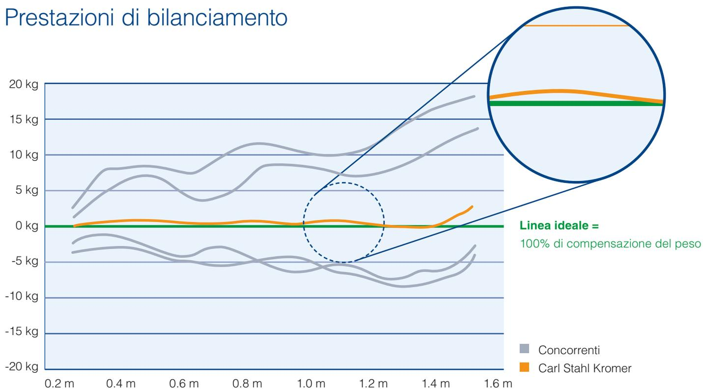
Diagramma della forza: misurazioni su un intervallo di estensione del cavo di 1,5 m
